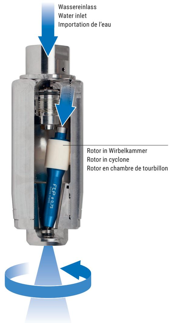
**MONRO-JET®** kann mit jeglichen Verschraubungen verwendet und auf Lanzen, Pistolen und Roboter montiert werden. Durch ihre spezielle Geometrie reinigt die **MONRO-JET®** sowohl im Freien als auch in Kanalisationen. Ihre Bauart verleiht dieser Düse Stabilität und Sicherheit.
