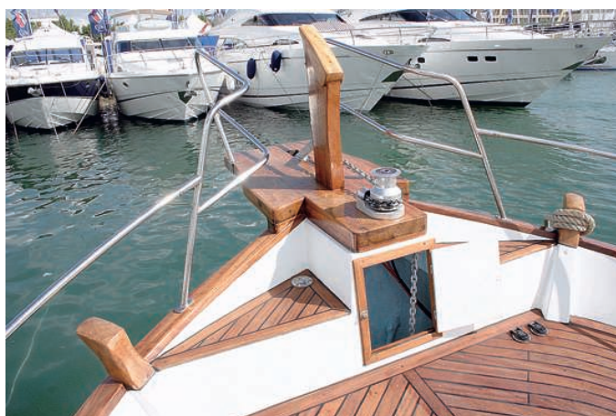
El pozo cuenta con una tapa vertical. Destaca el botalón y su balcón abierto para el desembarque por proa.
