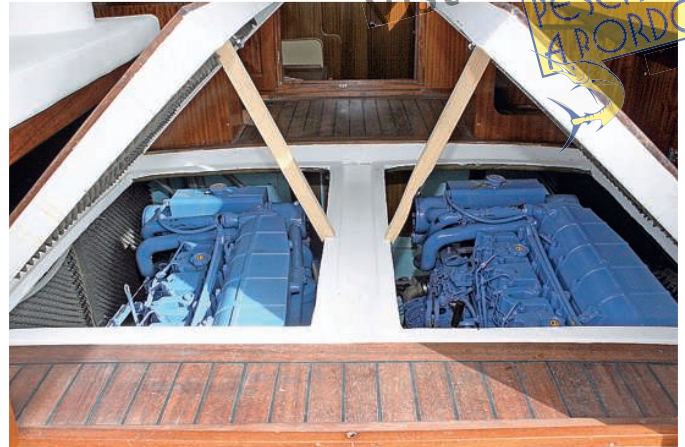
Sencillo sistema para aguantar las dos tapas de apertura a la cámara de motores.
