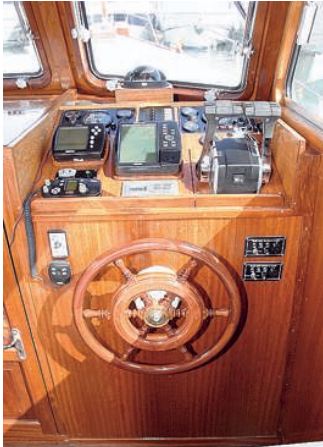
Todo el equipo de navegación y relojes de control de los motores queda concentrado en una pequeña superficie frente al puesto de gobierno.
