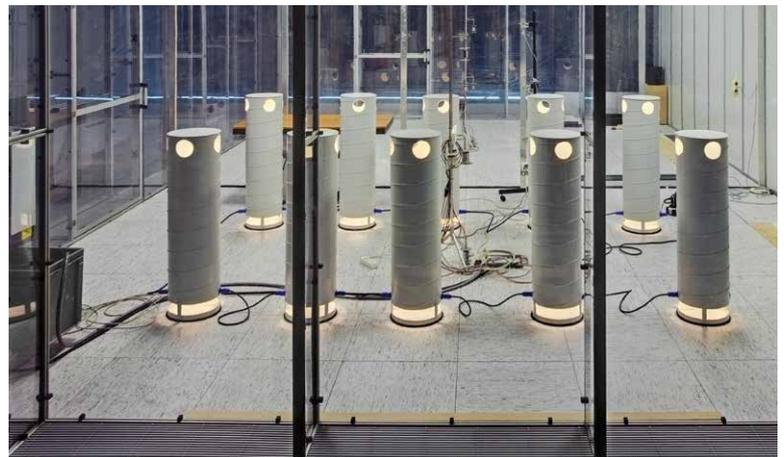
Wärme- und Kühlleistungsprüfkabine
