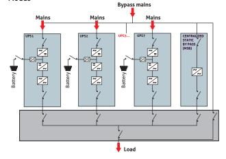
was wiederum die unterbrechungsfreie Energieversorgung beeinträchtigt, nimmt exponentiell mit der Größe der USV zu. Bei einem zentralisierten Bypass ist der statische Kreis unabhängig, und der Strom wird in einem einzigen Kanal verwendet, was eine Immunität gegenüber Iterationsproblemen zwischen den einzelnen USV-Einheiten gewährleistet.
