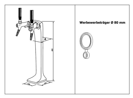
Bohrung in Theke: 1- 2 Hahnen 40 mm
