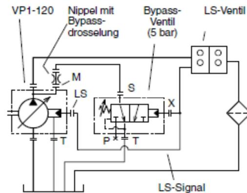
Hydraulik-Schaltplan für VP1-120 mit BPV-VP1.
