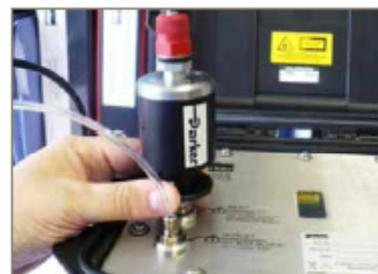
Zur Abnahme des Druckbegrenzungsventils (PRV) die Ausbauhilfe eindrücken und das PRV gleichzeitig anheben.
