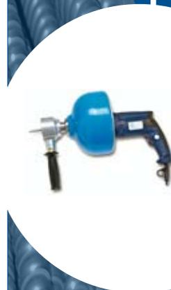
Die kleine und handliche Spiral-Rohrreinigungs-Maschine mit Elektromotor und automatischem Spiral-Vorschub und Rückzug ist geeignet für den Einsatz bis zum Fall- oder Hauptstrang. Der Motor ist stufenlos einstellbar von 0-1000 U/min. Durch die hohe Drehgeschwindigkeit der Spirale beim Zurückziehen wird das Rohr bis an die Wandung gereinigt.
