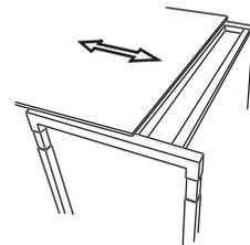
> jrs design tisch ist **mit einem Kabelkanal ausgerüstet**: Die Tischplatte kann standardmässig in Führungsschienen nach vorne gezogen werden, um den Kabelkanal zu erreichen ...
