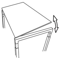
> zur ergonomischen Arbeit mit jrs design tisch ist das Gestell **auf Wunsch mit einer Schrägstellfunktion des Tischblattes** ausgerüstet: Das Tischblatt kann in drei Stufen bis 5 Grad – ohne Einsatz von Werkzeug und Schrauben – schräg gestellt werden.
