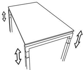
> das Gestell von jrs design tisch in der Standardausführung ist **manuell höhenverstellbar** von 680 mm bis 820 mm.
