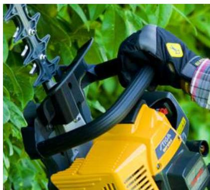
Une grosse poignée avant équipée d'une protection de lame, apporte sécurité et confort à son utilisateur.
