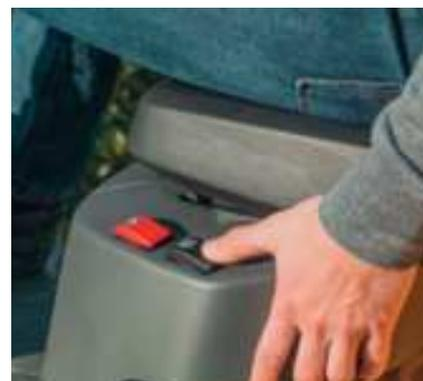
Réglage électrique de la hauteur de coupe. Le bouton rouge stoppe les lames pendant que le moteur est en marche. Pratique lors des traversées d'allées en gravier.
