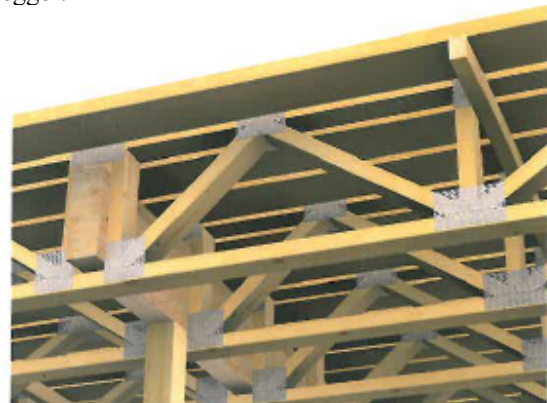
Fig 6. Gitterbjelkelag med tverrgående bærebjelke understøttet av søyle
