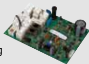
HDG Erweiterungsmodul EW-1 als Platinenerweiterung zur Regelung eines weiteren Heizkreises
