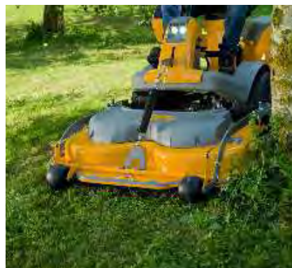
Das frontmontierte Combi Mähdeck mit bis zu 180 cm Schnittbreite, (für Pro Geräte) mäht den Rasen im Handumdrehen.
