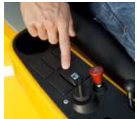
Dank der Bedienkonsole sind viele Einstellungen einfach zu meistern z.B. die elektrische Schnitthöheneinstellung oder das Bedienen des Mähdecks mit dem hydraulischen Geräteheber für Ausheben, Neutralstellung, Senken und Schwimmstellung.
