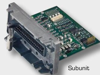
**digsy®compact** verfügt über die Flexibilität eines modular aufgebauten Systems und ist damit einfachen Kompaktsteuerungen überlegen. Das flexible Baukastensystem ist im Vollausbau mit zwei Modulen bestückt, wobei die Gesamtzahl der 110 Anschlusspins von der hohen Funktionalität zeugt.
