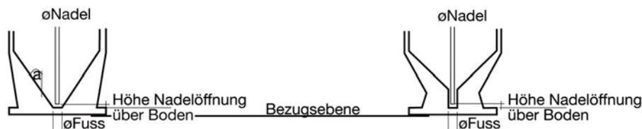
Bei der kegligen Ausführung bildet das Totvolumen ein Kegelstumpf mit dem Seitenwinkel  $a$  und bei der zylindrischen Ausführung wie von der Glastechnik Gräfenroda GmbH (GTG) gefertigt ein Zylinder.
