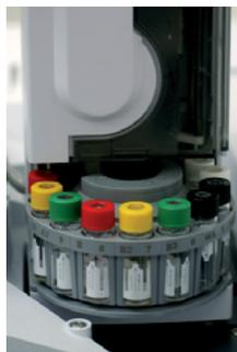
Bei Autosampler, die mit einer Spritze die Probe aus dem Autosamplervial entnehmen und dann injizieren, muss die Spritze nach jeder Injektion gespült werden, um die Verschleppung von einer Probe auf die nächste zu minimieren. Mit steigender Empfindlichkeit der Analyse, wird dieser Reinigungsschritt immer wichtiger, besonders, wenn verschiedene oder viskose Proben gemessen werden. Die Flaschen, in denen das
