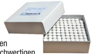
Lagervials mit „harter“ Schraubkappe aus Phenylharz, welche bis 120°C einsetzbar sind. Die Schraubkappen haben eine PTFE beschichtete Einlage. Vials und Schraubkappen werden zusammengesetzt in qualitativ hochwertigen weissen Kartonschachteln mit Rastereinsatz für 100 Vials geliefert, welche sich auch ideal für die Lagerung oder den Weiterversand eignen.
