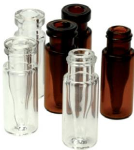
Unsere letzte Neuentwicklung ist das Mikroviel iV2 $\mu$ , bei welchem das Insert den Kopf des Vials trägt. Somit ist das Insert direkt verschlossen und die Probe kann sich nicht in die Aussenhülle verflüchtigen. Der Körper des Vials ist ein reines Hüllrohr das am Boden mit dem Insert fest verschmolzen ist. Wir produzieren diese Vials auf
