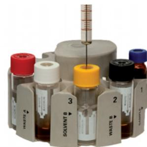
Das nutzbare Volumen ist 2 ml, das heisst bei 3 facher Spülung à 10 µl kann mit einer Waschflasche die Spritze bei ca 65 Injektionen gespült werden. Auch wenn die Waschflasche immer nur mit sauberem Lösungsmittel gefüllt wird, verunreinigt die Spritze das Vial und den Diffusionseinsatz; wir empfehlen deshalb die Waschflasche regelmässig zu wechseln, spätestens nach 100 Injektionen. Dasselbe gilt für die Abfallflasche, welche aber länger verwendet werden kann.
